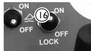
I normal position – **LOCK OFF** – flyder hydraulikolien i serie fra motor til motor. Hvis **LOCK ON** vælges, flyder olien parallelt mellem motorerne i samme side, svarende til en differentialespærre i drift. Hvis maskinen ikke har kørekredsløbsventil, kan olien ikke flyde mellem de højre og venstre hydraulikmotorer.
