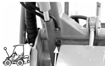
Sørg for at bommen holdes oppe under vedligeholdelses opgaver ved at sætte servicelåsen under løftecylinderens stempelstang. Sikring af servicelåsen laves ved at låse den til stempelstangen med den bolt, servicelåsen er monteret under sæderammen med.
