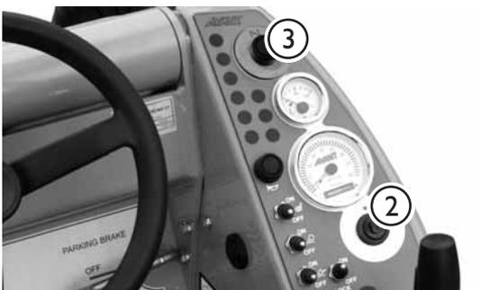
5. Drej tændingsnøglen ② til højre. Hvis motoren er kold, trykkes der på chokeren ③ og hold den nede.
