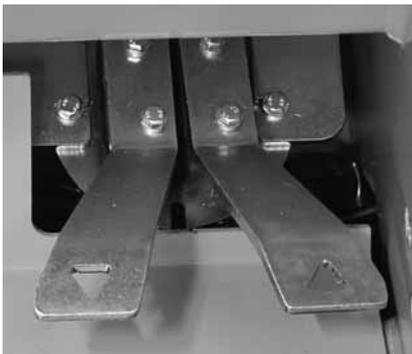
AVANT 500 seriens minilæssere er udstyret med et hydrostatisk køresystem, der er en variabel hydraulisk kørepumpe i systemet, hvis oliemængde trinløst styres med de to kørepedaler. Kørepedalerne fungerer proportionalt i styringen af kørehastigheden og den kraft, der er til rådighed for køremotorerne.
