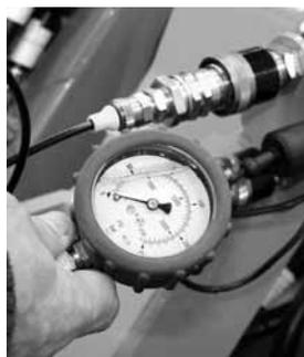
**Køretryk:** For at kontrollere trykket i køresystemet er det nødvendigt at montere en trykmåler i tryklinien i hvert tilfælde, hvis trykket synes at være forkert. Der er to trykdigningsventiler (en for forlæns kørsel og en for baglæns kørsel) med et forudindstillet tryk på 300 bar.
